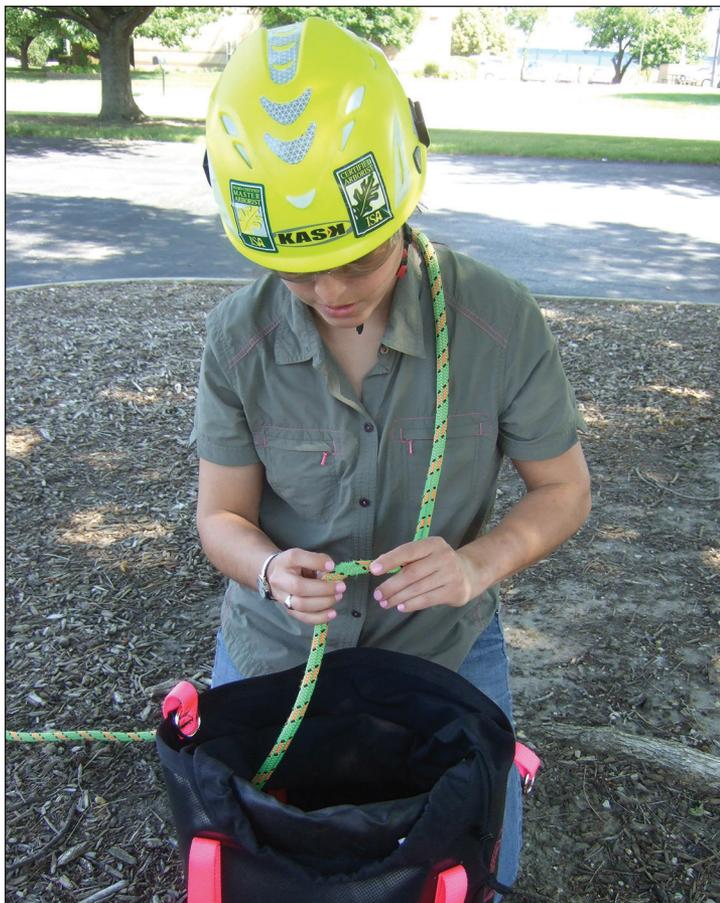
*Bild einer Seilprüfung: ANSI Z133 Safety Requirements for Arboriculture Operations section 8.1.4 sagt: "Arboristen müssen ihre Kletterseile, Arbeitsseile, Bandschlingen und anderes Klettermaterial auf Schäden, Schnitte, Abrieb und/oder Verschleiß vor jedem Einsatz prüfen und müssen Sie aus dem Gebrauch nehmen, wenn Zeichen von starker Abnutzung oder Schäden gefunden werden."*
