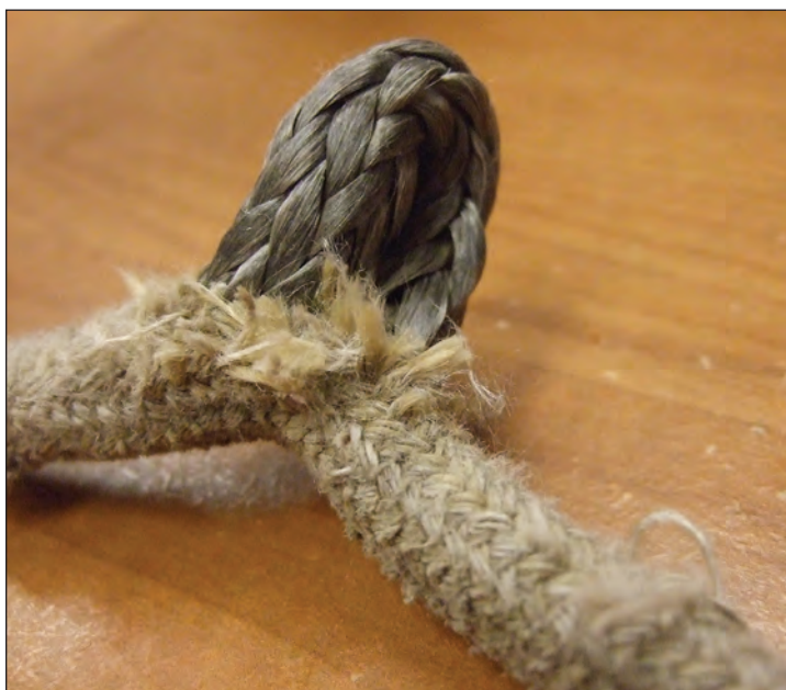
Cuerda dañada. Si más de la mitad de la cubierta está deshilachada o el núcleo de la cuerda está fruncido o abultado, se debe descartar la cuerda de inmediato.
