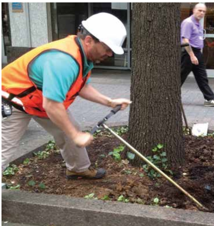
Während des Pflanzenwachstums müssen deren Wurzeln den Boden durchdringen. Wenn der Boden zu dicht ist und Wurzeln nicht in diesen eindringen können, kann das Pflanzenwachstum beschränkt werden. Um zu bewerten, welchem Widerstand Wurzeln gegenüberstehen, kann eine möglichst ungestörte Bodenprobe entnommen (Stechzylinder) oder ein Bodenpenetrometer verwendet werden.
