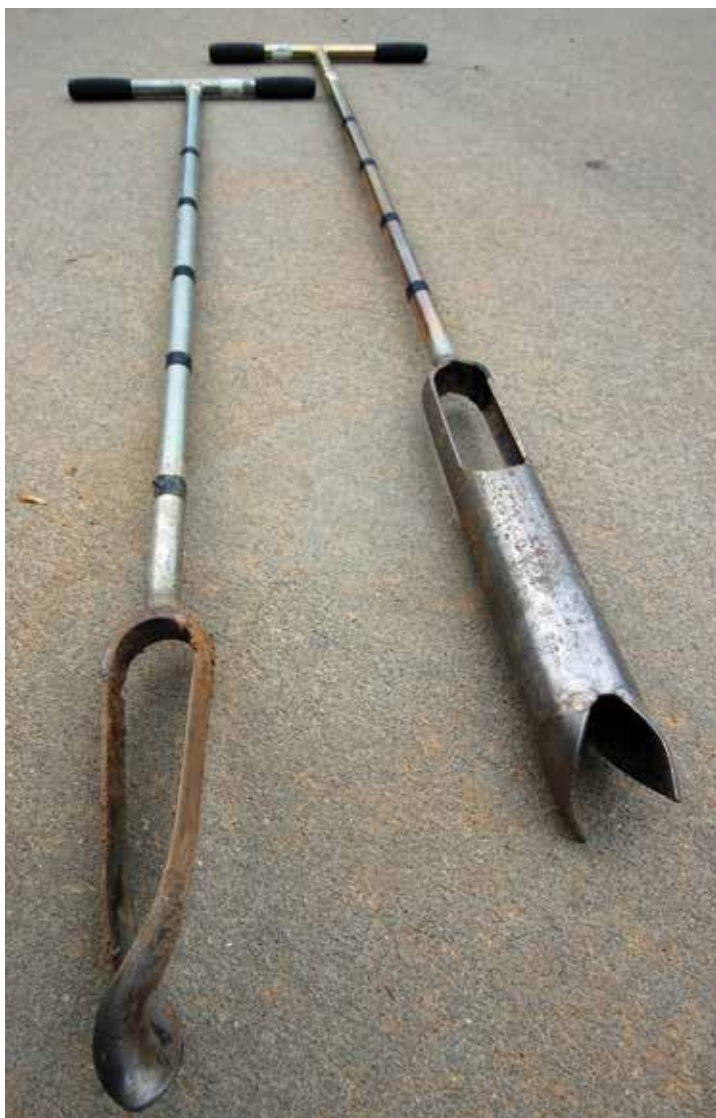
Las sondas de muestreo de suelos son tubos de acero, usualmente de \frac{3}{4} a 1\frac{1}{4} de pulgadas (de 2 a 3 cm) de diámetro, con una punta diseñada para tipos de suelo específicos, un mango, y a veces un apoyapié conectado al tubo para introducir la sonda en el suelo.
