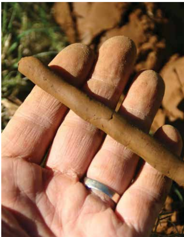
El método en campo más común para determinar la textura del suelo es el “método del tacto”. Esta técnica involucra humedecer y amasar el suelo, hacer un rollo, medir su longitud, y entonces evaluar su aspereza y tersura relativas.
