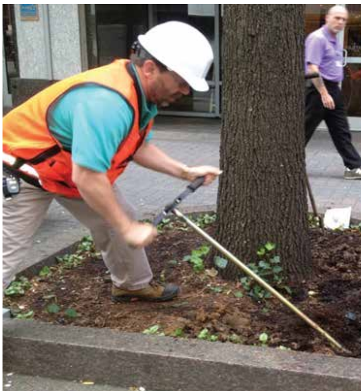
A medida que las plantas crecen, sus raíces deben penetrar el suelo. Si el suelo es demasiado denso para que las raíces puedan penetrar, el crecimiento de la planta puede verse limitado. Para estimar cuánta resistencia enfrentan las raíces, se puede utilizar una sonda para suelos sólidos o un penetrómetro de suelos.
