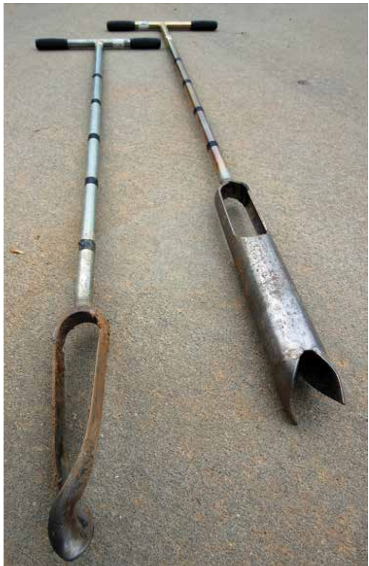
Las barrenas para perforar el suelo son tubos de acero, normalmente de \frac{3}{4} a 1\frac{1}{4} de pulgada (2 a 3 cm) de diámetro, con una punta cuyo diseño varía según el tipo de suelo a perforar, una empuñadura, y a veces un reposapié conectado al tubo principal para ayudar a introducir la herramienta en el suelo.
